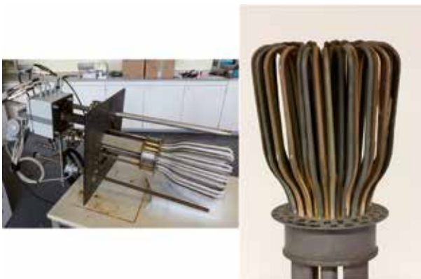
Abb. 1: Prüfling zu Beginn und am Ende des Dauertests
