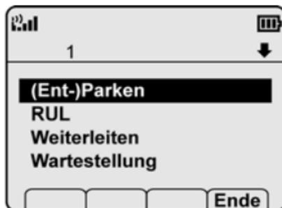
Dieses Display wird durch Drücken der **FCN**-Taste bei abgenommenem Hörer aufgerufen. Es zeigt eine Liste von Funktionen an, die während eines Anrufs aktiviert werden können. Verfügbare Funktionen hängen von der Konfiguration Ihres Kommunikationsservers ab. Die Pfeil-Symbole zeigen zusätzliche Menüpunkte an. Die **Ende**-Funktionstaste bringt Sie zum Display des aktiven laufenden Gesprächs zurück.
