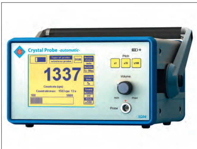
Abbildung 7: Die SLN-Sonde der Firma Crystal Photonics liefert am analogen Ausgang das Signal, das mit der USB-Messkarte aufgenommen wird. Intraoperativ wird vom Chirurgen das Gewebe manuell abgesucht, um die Lage des Wächterlymphknotens zu detektieren, dabei wird sich an der steigenden Countrate (cps) am Display orientiert. [4]
