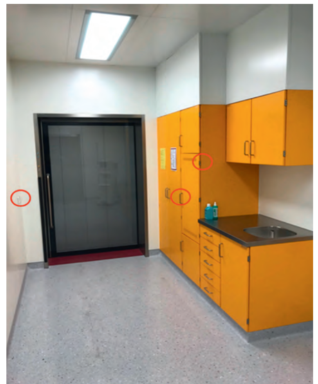
Abbildung 2: Beispieloberflächen zur Beurteilung der hygienisch relevanten Oberflächen mit gekennzeichneten Prüfpunkten des Fresenius 4008S Hämodialysegeräts (oben) und Vorbereitungsraums des Forschungs-OP (unten)
