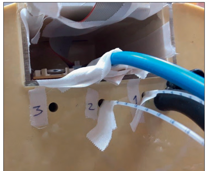
Abbildung 3: Messaufbau in der Brachytherapie. Die Platine ist im Einschubmodul platziert. Des Weiteren wurde eine Ionisationskammer eingeführt um die Dosis an der Platine/Bauteilen zu verifizieren.
