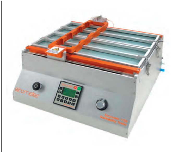
Abbildung 5: Elcometer 1720 für standardisierte Abriebversuche
