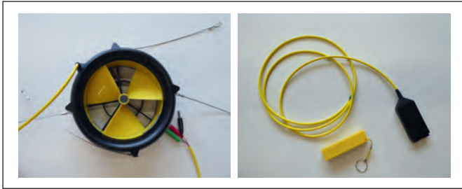
Abbildung 1: Rucksackturbinen WaterLily (links) mit USB-Schnittstelle und Powerbank (rechts)
